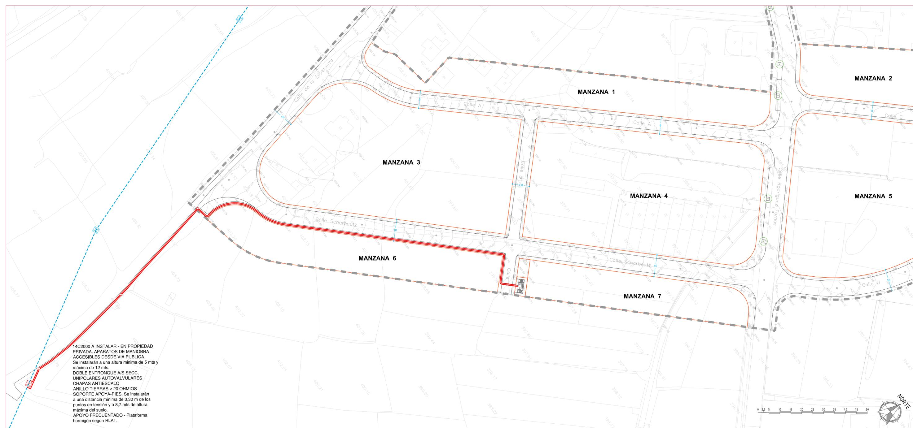
14C2000 A INSTALAR - EN PROPIEDAD PRIVADA. APARATOS DE MANIOBRA ACCESIBLES DESDE VIA PUBLICA. Se instalarán a una altura mínima de 5 mts y máxima de 12 mts. DOBLE ENTRONQUE A/S SECC. UNIPOLARES AUTOVALVULARES CHAPAS ANTIESCALO ANILLO TIERRAS < 20 OHMIOS SOPORTE APOYA-PIES. Se instalarán a una distancia mínima de 3,30 m de los puntos en tensión y a 8,7 mts de altura máxima del suelo. APOYO FRECUENTADO - Plataforma hormigón según RLAT.
